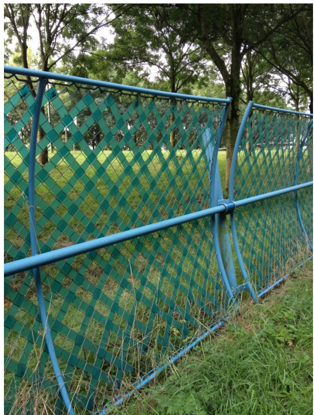
Figur 30 – Testforsøg med vindafskærmning med 40 % luftgennemstrømning.
